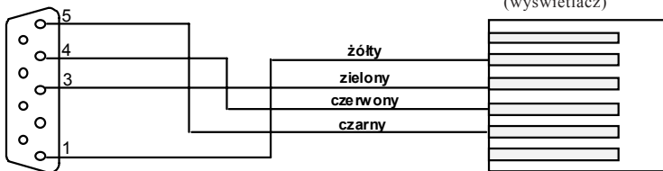
Rys.6 Schemat połączeń kabla K-009 łączącego centralę lub ZI2 z pierwszym wyświetlaczem ZW1 .
