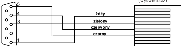
Rys.6 Schemat połączeń kabla K-009 łączącego centralę lub ZI2 z pierwszym wyświetlatczem ZW1 .
